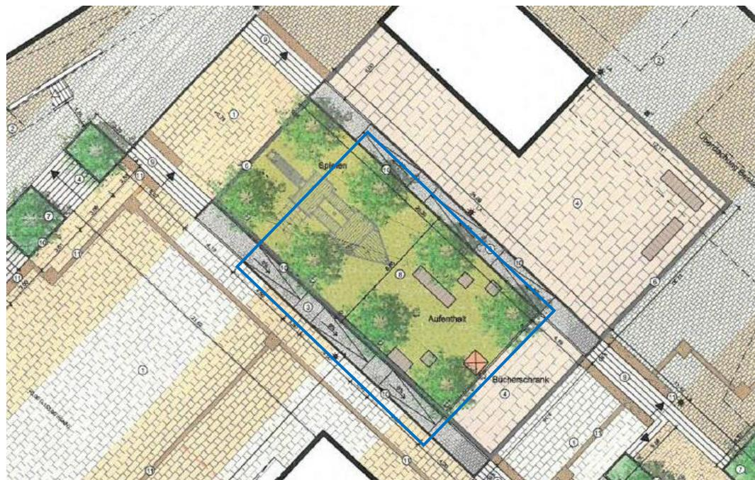
**Abb. 2:** Ausschnitt aus der Entwurfsplanung für die Freianlagen, Stand März 2019 im Maßstab 1:100 der Planergruppe ROB. Das Niveau im blau umrandeten Bereich ist nach derzeitigem Planungsstand ca. 1,00 Meter höher als zum jetzigen Zeitpunkt.
